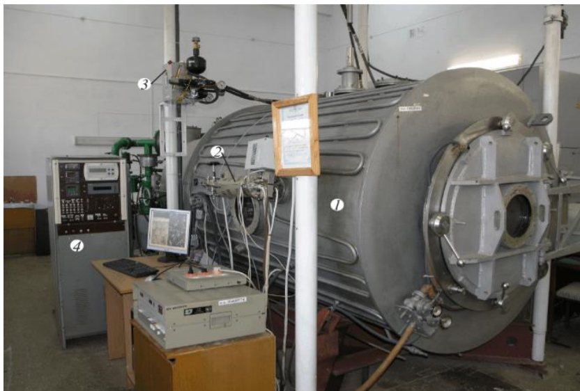
Зовнішні вигляд установки ВВУ-1Д після модернізації: 1 – камера; 2 – масс-спектрометр; 3 – система навантаження; 4 – пульт управління
