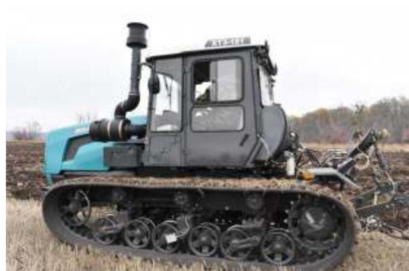
Рис. 4.14 – Тягові випробування трактора ХТЗ-181.20-07
