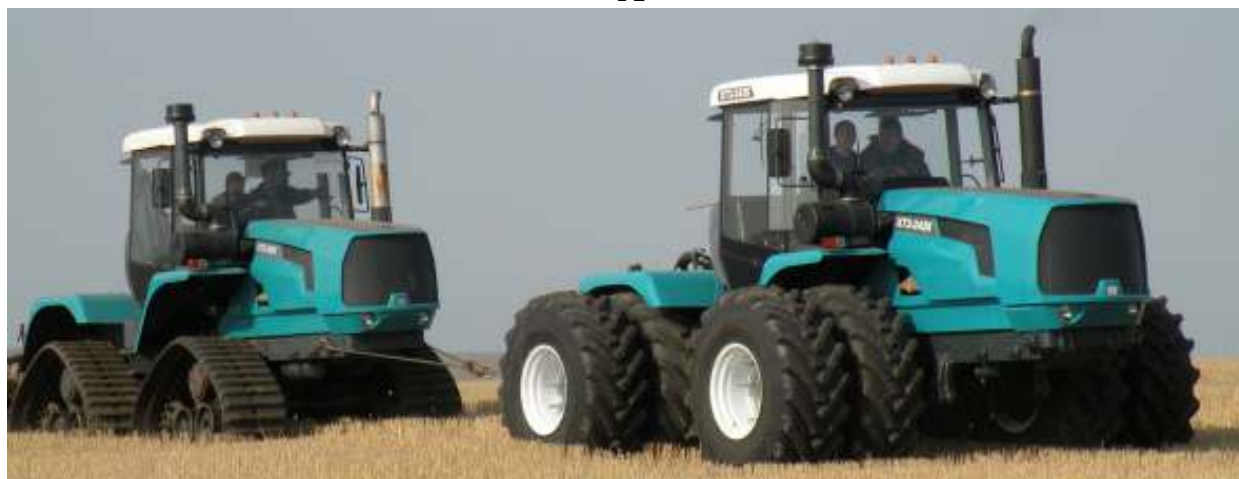
Рис. 4.13 – Тягові випробування трактора ХТЗ-242К: А – на одинарних колесах; Б – на здвоєних колесах
