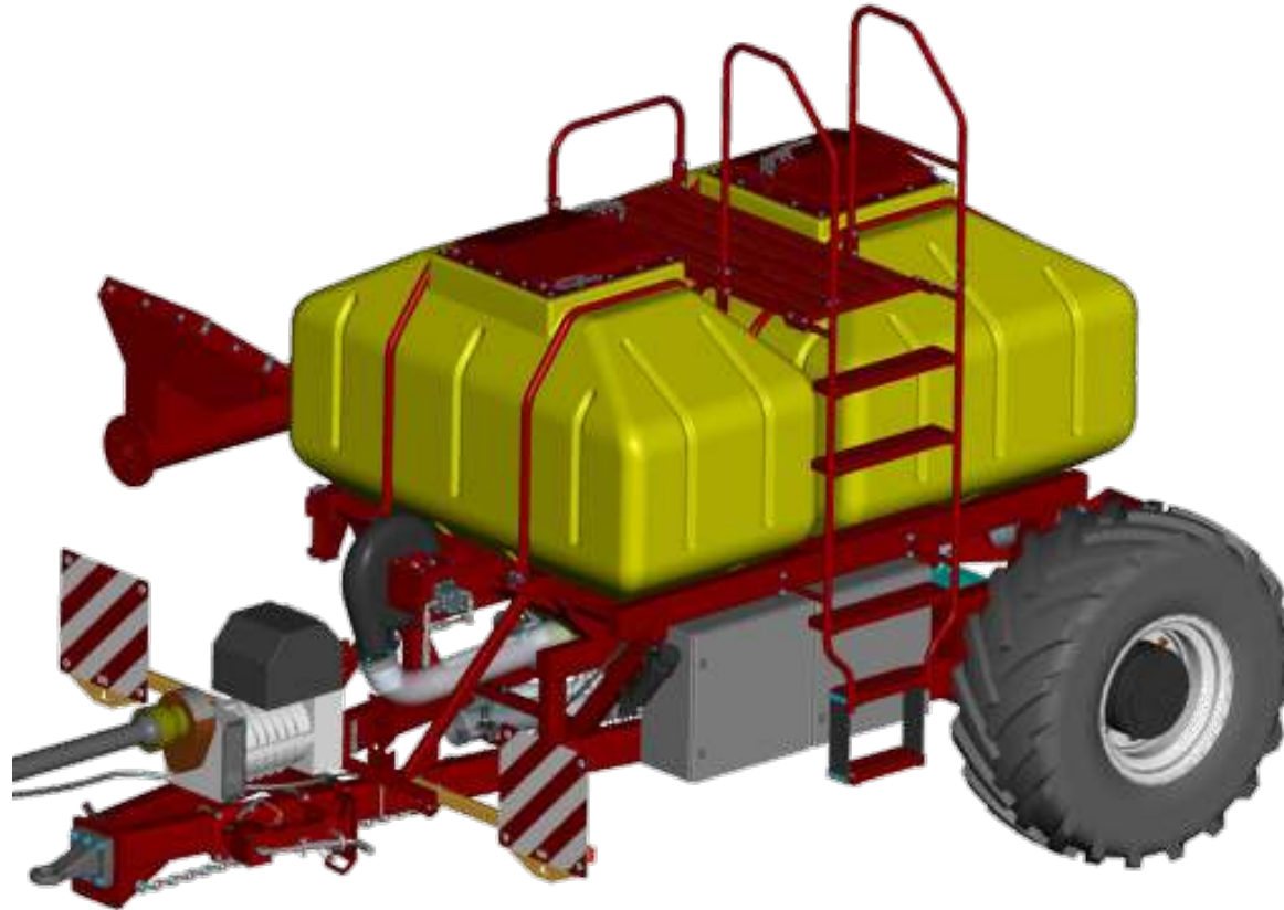
Рис. 4.14 – Бункер посівного комплексу Златнік-6/5000-SED виробництва Індустріальної групи «УПЕК» із електроприводними колесами
